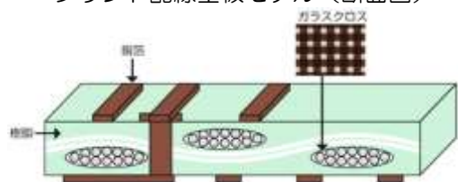
プリント配線基板モデル（断面図）
