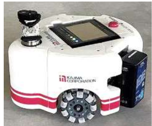
墨出しロボット「ロボプリン」 HPより
